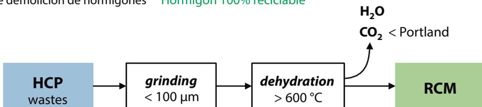
Reactivación térmica de residuos de cemento hidratado
